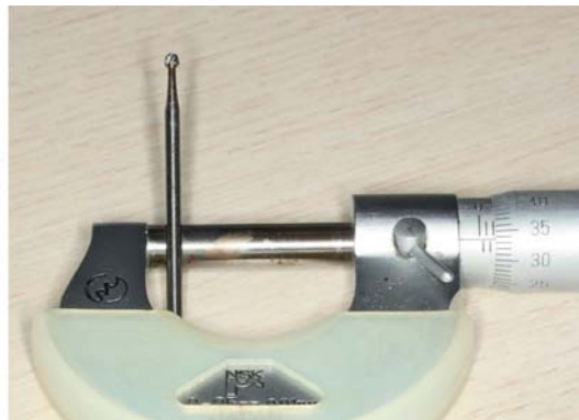
Figuras 12 Todo transferente precisa receber o seu análogo correspondente: o análogo do implante bicortical foi representado por uma broca para peça de mão, pois se vertermos gesso dentro do transferente fatalmente vai quebrar. O calibre da broca é igual ao corpo do implante de ativação imediata bicortical.
