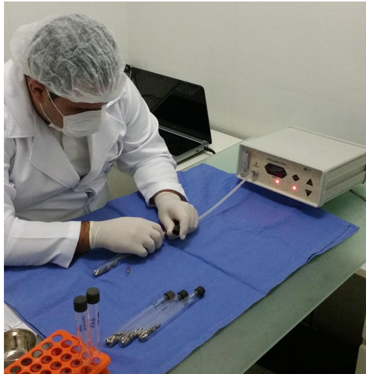
Figura 7 Mensuração dos gases com o Halimeter™
